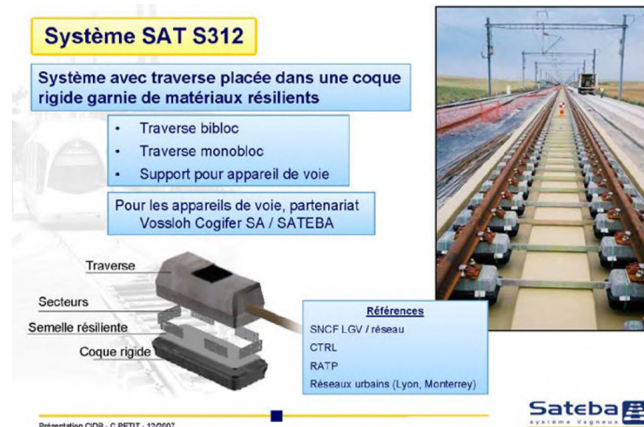
Figure 74 : Exemple de traverse bi-bloc SAT S312 (Source : Sateba)
