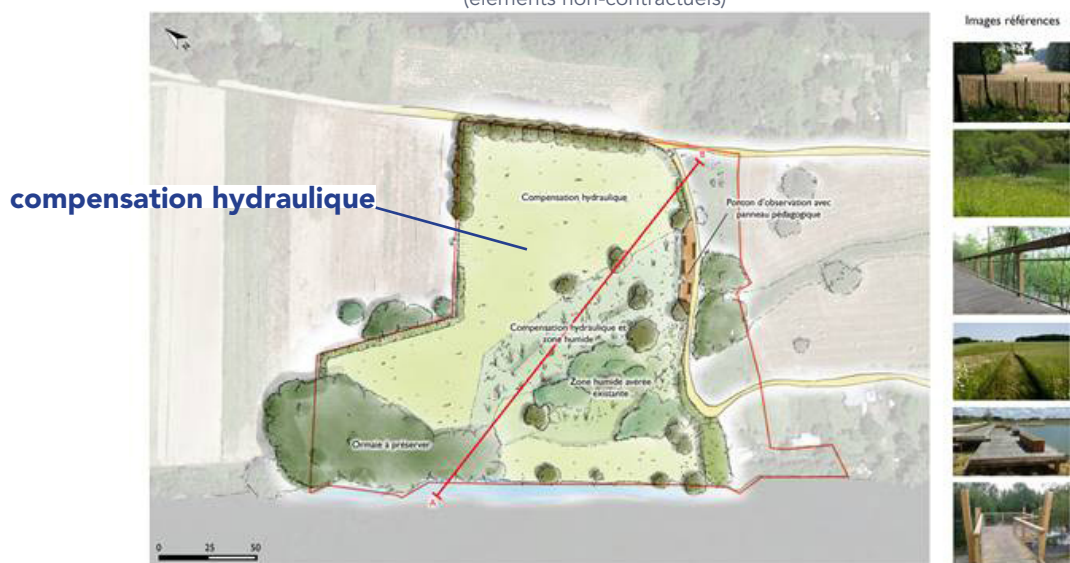
Projet d'aménagement pour compensation hydraulique et zone humide sur la parcelle BL118 (éléments non-contractuels)
