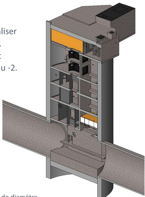
Le puits Gouraud mesure 41 mètres de profondeur et 20 mètres de diamètre.
